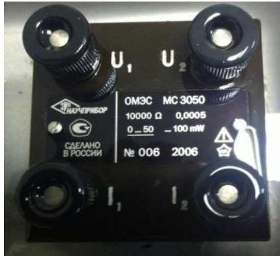
Рисунок 1. Однозначная мера электрического сопротивления МС3050 из состава государственного эталона единицы электрического сопротивления
