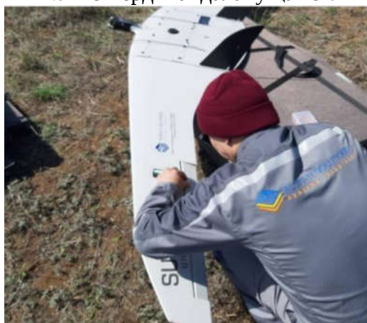
1 – сурет. S upercam S350 ұшқышсыз ұшу аппараты
