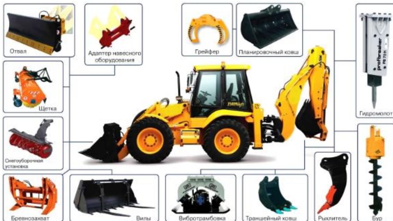
Рисунок 1. Модельный ряд перекомпануемого сменного оборудования для широкого круга работ на базе экскаватора-погрузчика компании JCB (<https://Ekskavatory-pogruzchiki-navesnoe-oborudovanie>).
