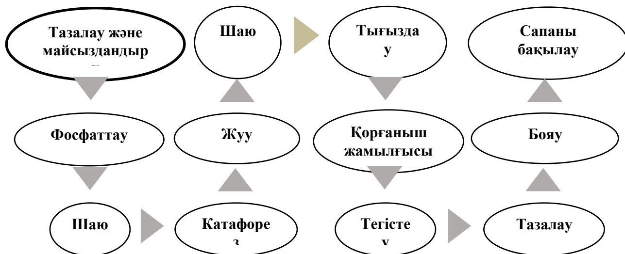
Сурет 1. Дайындаушы зауытта шанақты бояудың технологиялық процесі
