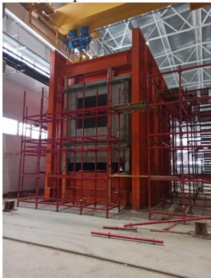
Рисунок 7. Испытательный стенд несущей способности модульных блоков
