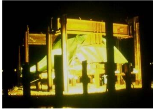
Сурет 12: Өлі жүктермен (сол жақта) және реактивті рамамен (оң жақта) статикалық жүктемені сынау
