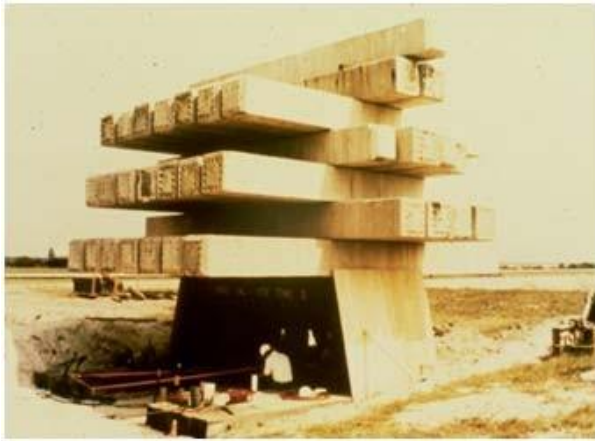
Сурет 12: Өлі жүктермен (сол жақта) және реактивті рамамен (оң жақта) статикалық жүктемені сынау
