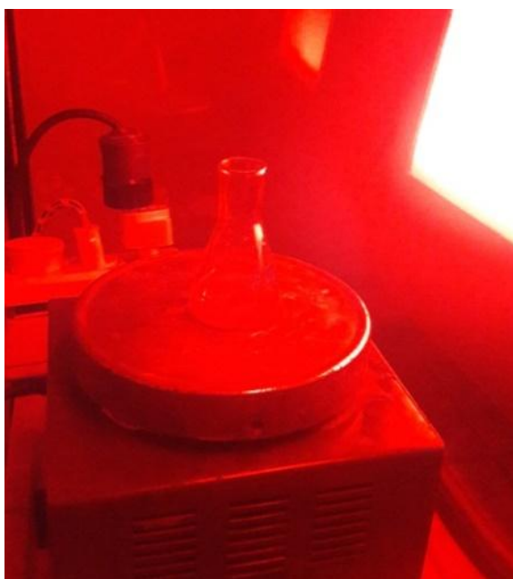
2-сурет. 7% HCl қышқылында үлгілерді өңдеу
