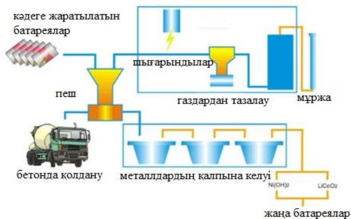
Сурет 2- Литий-ионды батареяларды утилизациялаудың пирометаллургиялық әдісі
