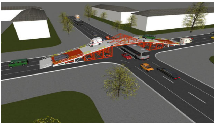
Сурет 6 – Мобильді жол өтпесінің 3D сұлбасы
