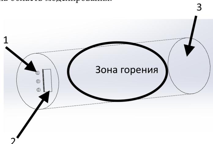
1 – сопла для подачи топлива, 2 – уголкового стабилизатор, 3 – выход из зоны горения
