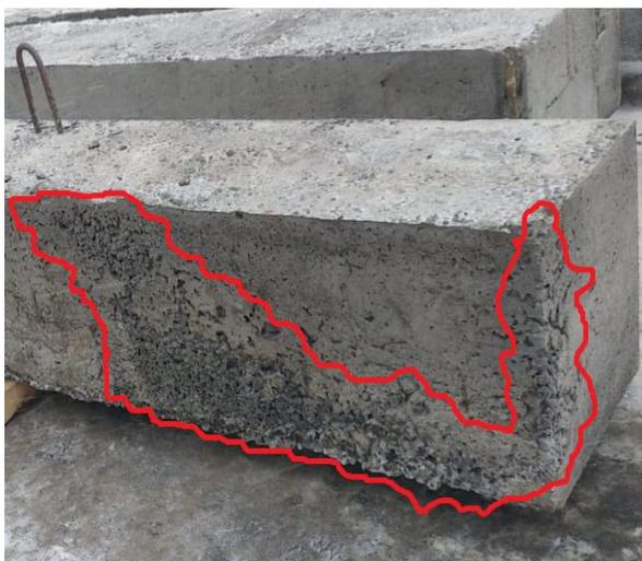
Рисунок 5. Образование раковин в теле бетона
