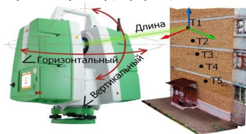
Рисунок 1 – Принципиальная схема метода наземного лазерного сканирования
