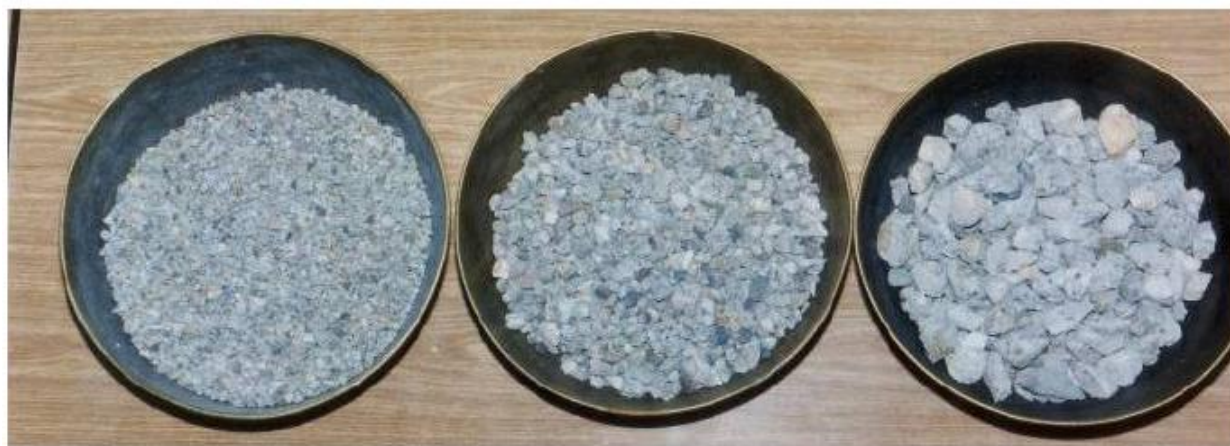
№1 Сурет. Үгітілу арқылы алынған және табиғи құрамды қиыршық тастар: солдан оңға қарай 4-8мм, 8-16мм, және ірі толтырғыш- 16-31,5мм.
