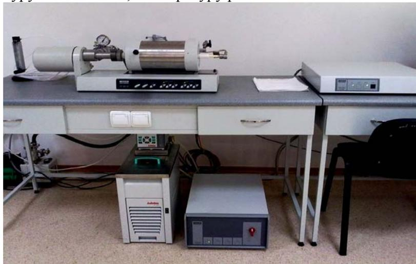
Рисунок 1. Внешний вид дилатометра DIL-402CD.
