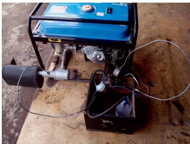
Фото 3 – Система питания ДВС на крекинг-газе на стационарном ДВС
