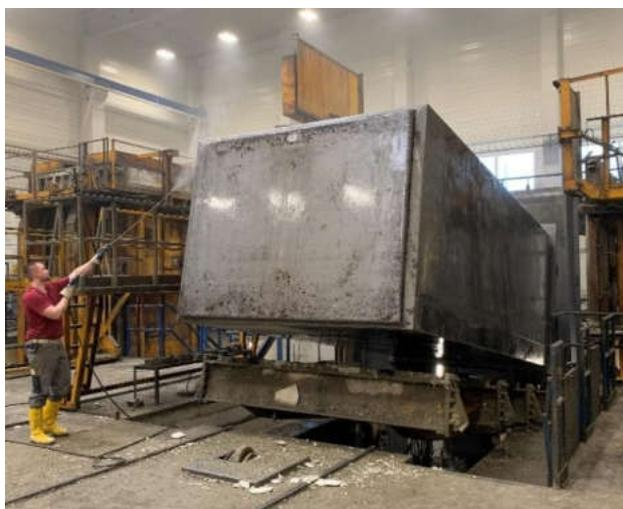
Рисунок 9. Сжимающийся сердечник, Дюльмен (Германия)
