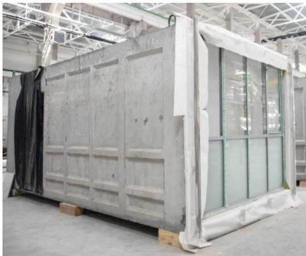
Рисунок 7. Объемный блок по типу «лежащий стакан», Нур-Султан (Казахстан)
