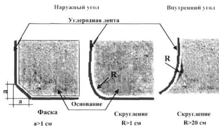
Рис. 4. Подготовка углов конструкции перед наклейкой композитного материала
